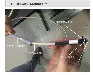
FILTER POSITION FOR LED INSTALLATION 🔻
